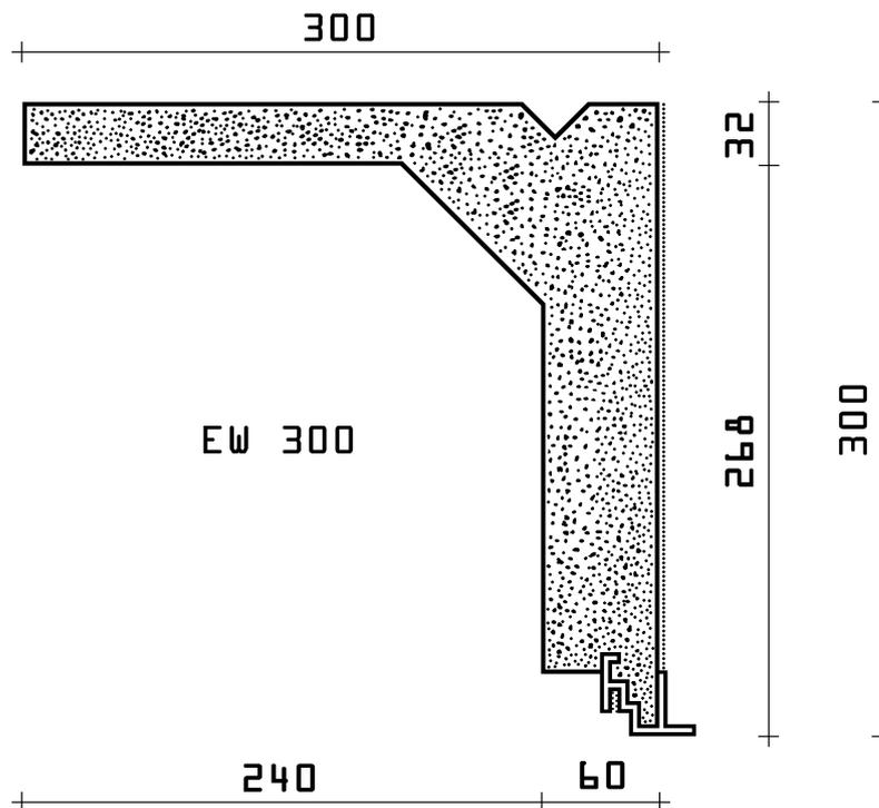
Serienmäßig haben alle Rolladenkästen der Typenreihe EW eine spezielle **Clip - Innenschiene** für den einfachen, schraublosen **EASY - CLIP - Deckelanschluss**, mit 15 mm Ausladung.
